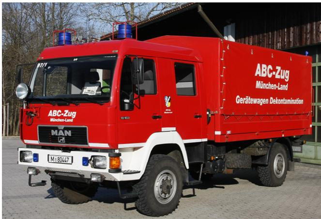
Der **Gerätewagen Dekontamination** kommt dann in den Einsatz, wenn Einsatzkräfte vor dem Verlassen des Gefahrenbereichs dekontaminiert werden müssen. Das gleiche gilt, wenn eine Vielzahl von Personen mit gefährlichen Stoffen in Kontakt gekommen ist. Die auf ihm verlasteten Duschzelte erlauben es, bis zu sechzig Personen pro Stunde zu entgiften. Ergänzt wird diese Ausstattung durch das Modul des Freistaats Bayern zur Dekontamination von Verletzten, so dass dieses Fahrzeug
