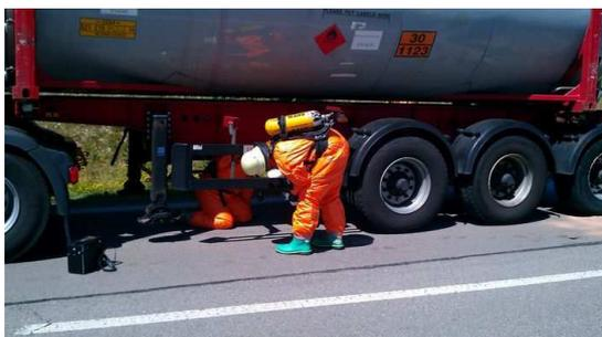
Mit Hilfe eines Photoionisationsdetektors und unter Einsatz von Prüfröhrchen wurde die Stoffkonzentration in der Umwelt ermittelt.
