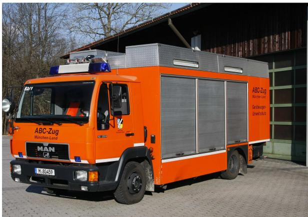
Der **Gerätewagen Umweltschutz** enthält die Ausstattung, die bei Chemieunfällen für die Tätigkeit direkt an der Schadenstelle erforderlich ist: Auffangen und Analysieren der austretenden Stoffe, Abdichten der Leckage und Abpumpen der Chemikalien. Dazu trägt das Fahrzeug eine Reihe an Messgeräten für eine Vielzahl gasförmiger und flüssiger Gefahrstoffe. Mit der mitgeführten Schutzbekleidung bis hin zum hermetisch abschließenden Chemikalienschutzanzug können mehrere Trupps ausgerüstet werden.
