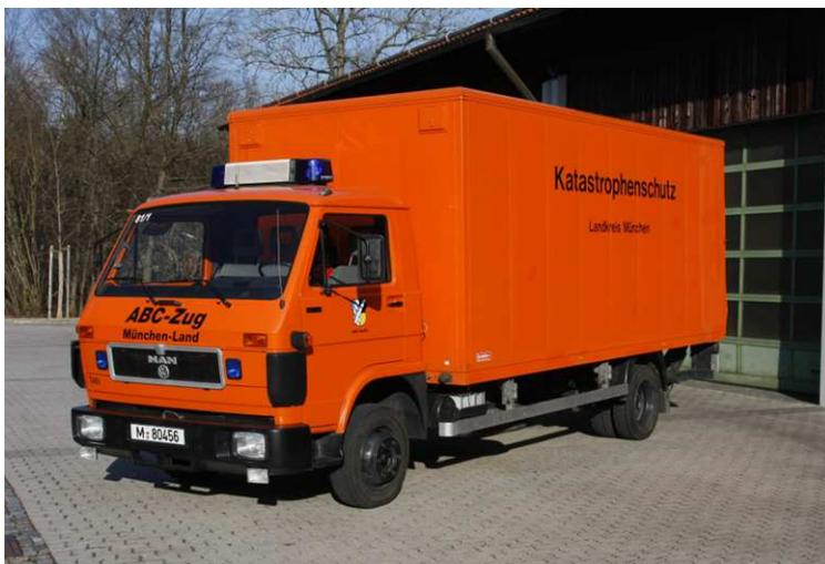
Die Ladefläche des **Mehrzweck-Lkw** wird für den Transport von individuell benötigten Großgeräten wie Überfässern und Dekontaminationsmitteln verwendet. Solche Ausstattungen sind in den Fahrzeughallen des Gerätehauses in sogenannten Gerätesätzen palettiert zusammengefasst, um so besonders schnell auf dem Lkw verlastet werden zu können. Sogar eine Trinkwasseraufbereitungsanlage wurde mit dem Fahrzeug bereits in einen Einsatz gebracht.
