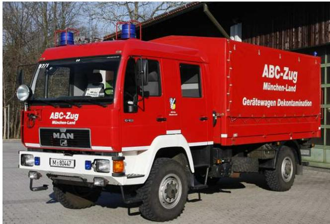
Der **Gerätewagen Dekontamination** kommt dann in den Einsatz, wenn Einsatzkräfte vor dem Verlassen des Gefahrenbereichs dekontaminiert werden müssen. Das gleiche gilt, wenn eine Vielzahl von Personen mit gefährlichen Stoffen in Kontakt gekommen ist. Die auf ihm verlasteten Duschzelte erlauben es, bis zu sechzig Personen pro Stunde zu entgiften. Ergänzt wird diese Ausstattung durch das Modul des Freistaats Bayern zur Dekontamination von Verletzten, so dass dieses Fahrzeug eine
