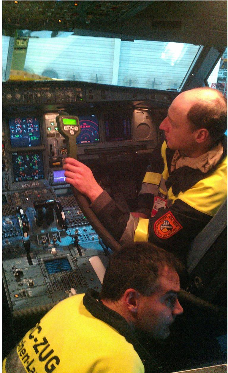
Das Gaschromatographie-Massenspektrometer im Einsatz am Münchner Flughafen. Unbekannter Geruch im Cockpit eines Airbus führte den ABC-Zug dorthin.
