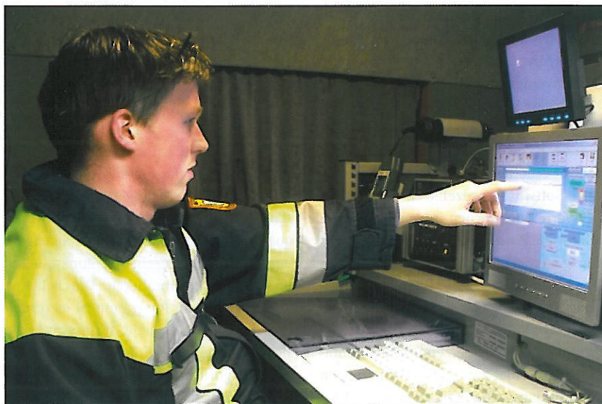
Im ABC-Erkundungskraftwagen werden die Messwerte am Computer ausgewertet. Dazu sind Darstellungen als Diagramm, als Tabelle und in einer topografischen Karte möglich.
